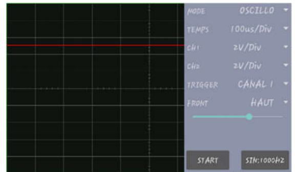
L'appui sur le bouton situé à côté du bouton START permet de configurer le GBF (choix du signal à générer et de la fréquence du signal). Une fois la configuration validée le bouton affiche la forme d'onde du signal généré ainsi que la fréquence. Sur l'exemple le générateur génère un signal sinus (SIN) de 1KHz.
