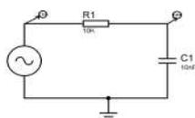
Dans cet exemple le GBF du PhysicistLab est utilisé pour générer un signal (sinus ensuite carré) de fréquence 1KHz puis l'oscilloscope visualise les signaux afin de montrer l'influence du condensateur dans le circuit.
