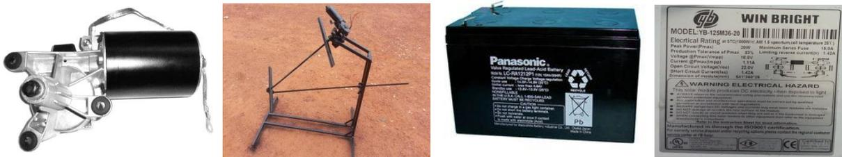
Image3, 4, 5, 6 : Moteur 12V-100mA minimum, Système mécanique articulé 1.1mètre en longueur et 0.45 mètre en largeur, Batterie 12V/7.0AH, spécifications panneau solaire (18V,1.1A)
