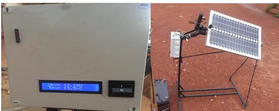
Image1 & 2 : Mini centrale d'acquisition et d'enregistrement des données numériques (gauche)-Kit de contrôle et d'acquisition de données pour suiveurs solaires (droite).
